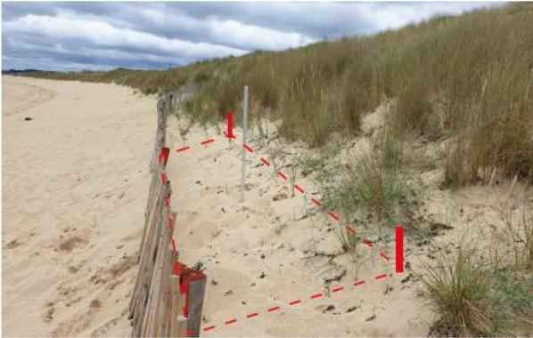
**4** : Sur le poteau central, et à l'aide du ruban mètre, Mesurer la distance entre le haut du poteau rouge et le sable
