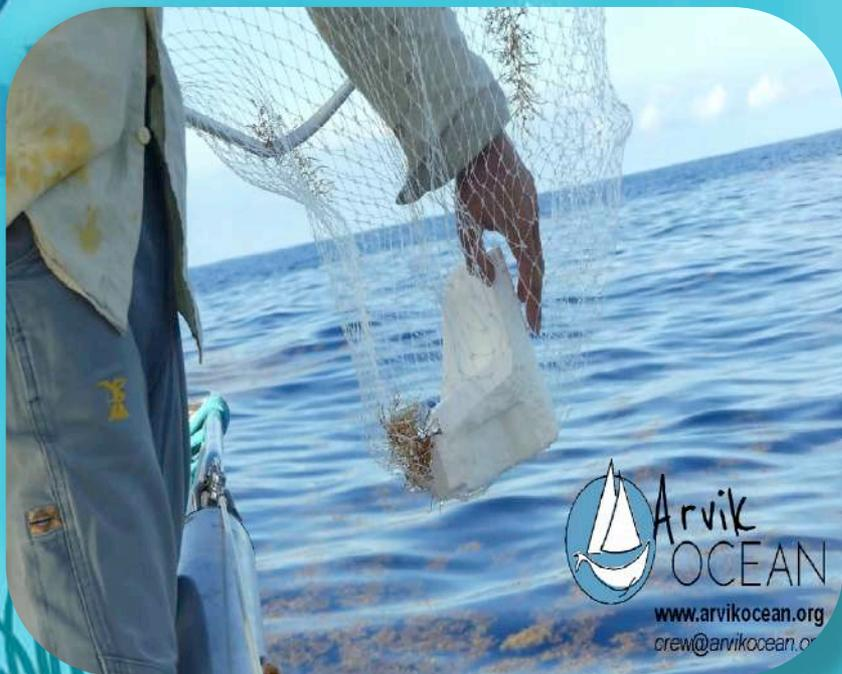
Elaboration en 2022, d'un Kit plaisance permettant le ramassage en mer des déchets flottants et leur caractérisation à bord des navires. L'utilisation d'un sac de jute pour stocker les déchets a été abandonnée (trop fragile).
