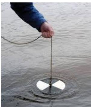
Faites descendre doucement dans l'eau le disque de Secchi jusqu'à ce que vous le perdiez de vue, puis vous le remontez doucement, votre cordage étant gradué, il vous suffit de compter les graduations au moment où il a disparu et le haut du cordage noter sur l'application RIEM OBS
